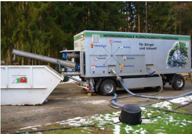
Abb. 1: Anlage zur interkommunalen Klärschlamm entwässerung
