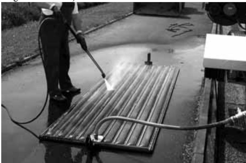
70 hPa gesenkt werden. Eine anschließend durchgeführten mikroskopischen Untersuchung an der gereinigten Membran hat gezeigt, dass aber eine Restverschmutzung verbleibt, die bei der Neubildung von Ablagerungen sicher beschleunigend wirkt.
