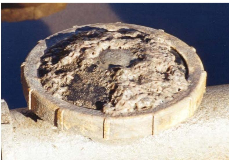
**Abbildung 8:** Verschleimtes Belüfterelement
