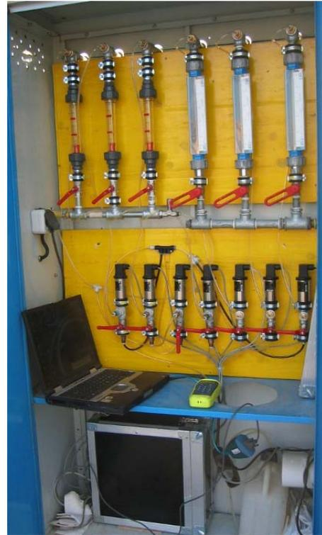
**Abbildung 2:** Messaufbau für Volumenstrom und Druckmessung
