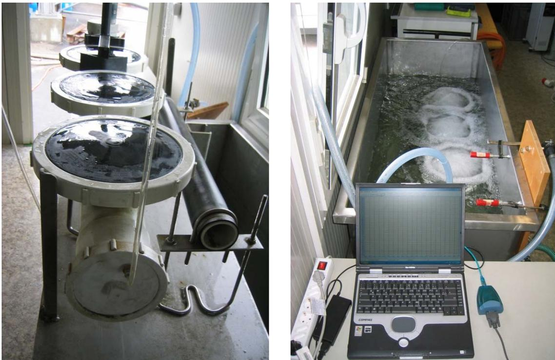
Abbildung 4: Druckmessung an aushebbaren Belüftern
