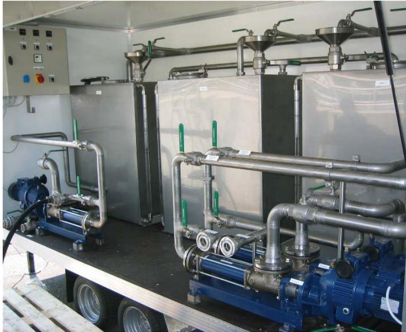
**Abbildung 15:** Aufbau der mobilen Reinigungsanlage
