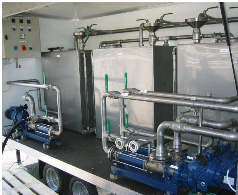
Die erforderlichen Behälter, Pumpen und verbindenden Rohrleitungen samt elektrischem Schaltschrank waren in einem Anhänger untergebracht. Die Beschickung und Entleerung der Container erfolgte mit den eingebauten Exzentrerschneckenpumpen. In Abbildung 15 ist der Anhänger mit Einbauten zu sehen.
