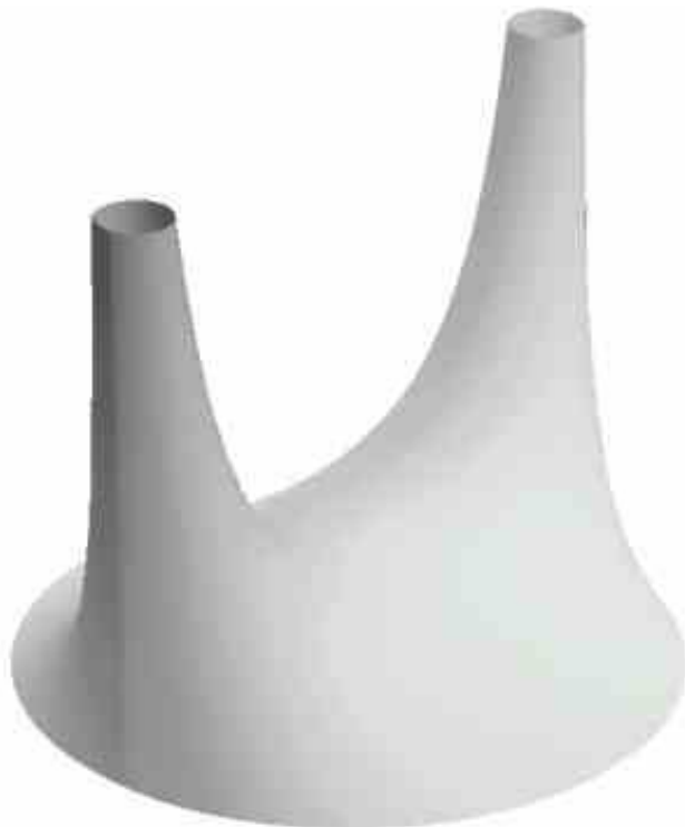
Abbildung 7: Wertigkeitsfunktion für Punktelektroden nach SHERCLIFF (1955)
