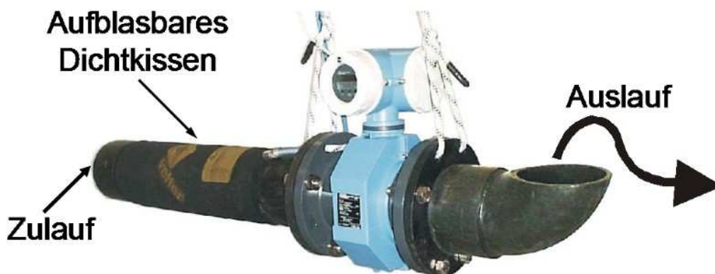
Abbildung 14: Mobile MID –Einheit zur Messung im Kanal
