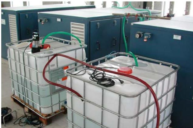
**Abbildung 6:** Vorlagebehälter für Reinigungsflüssigkeit
