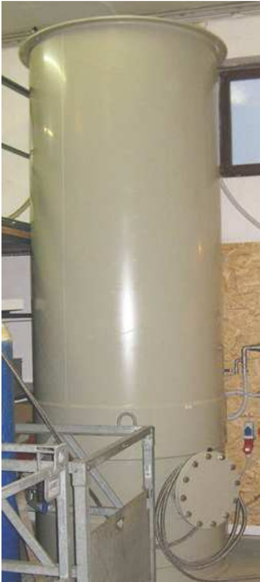
Abbildung 5: Prüfstand zur Ermittlung der Sauerstoffzufuhr
